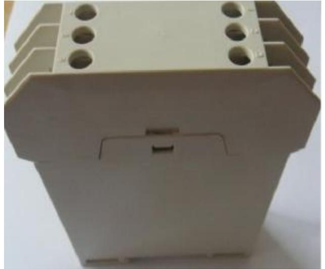
DIN35 安装的频率信号转电压电流变送器是把变送器输出线性的模拟频率转换成国际标准的电压电流信号输出，经过特殊处理在低频时产品可以达到 0.5% 的精度，对输入频率信号进行了高压嵌位，采用电流模式转换成频率信号，相比较有更高的抗干扰性能，内部有调零电位器与调满度电位器，可以拆开外壳可以进行微调，方便在工业现场的应用，通过高速光耦隔离，输入有两种型式：一种是脉冲信号输入，一种是集电极开路 NPN 三极管输入。
